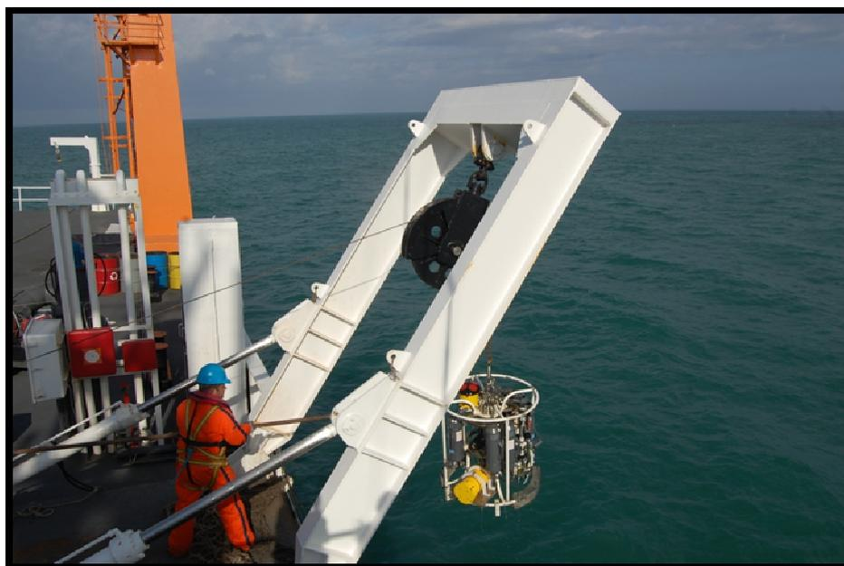
Estação oceanográfica sendo realizada pelo arco lateral com o apoio de guincho oceanográfico dotado de cabo eletromecânico de 4.500 m, conjunto CTD/rosette com 12 garrafas de NISKIN de 5 litros e L-ADCP.
